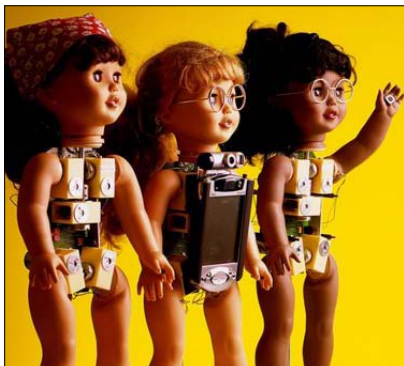
2. ábra. (bal oldal) Három Robota robot. A középsőt Compaq iPAQ 3850 processzorral szereltük fel. (jobb oldal) A Robota PocketPC-jére szerelt kamera lehetővé teszi, hogy a robot fénynyalábbal letapogassa a felhasználó kezét és orrát, és felismerje bőrszínét. Robota ezáltal képessé válik a felhasználó kéz- és fejmozdulatainak tükröképszerű utánczására.
